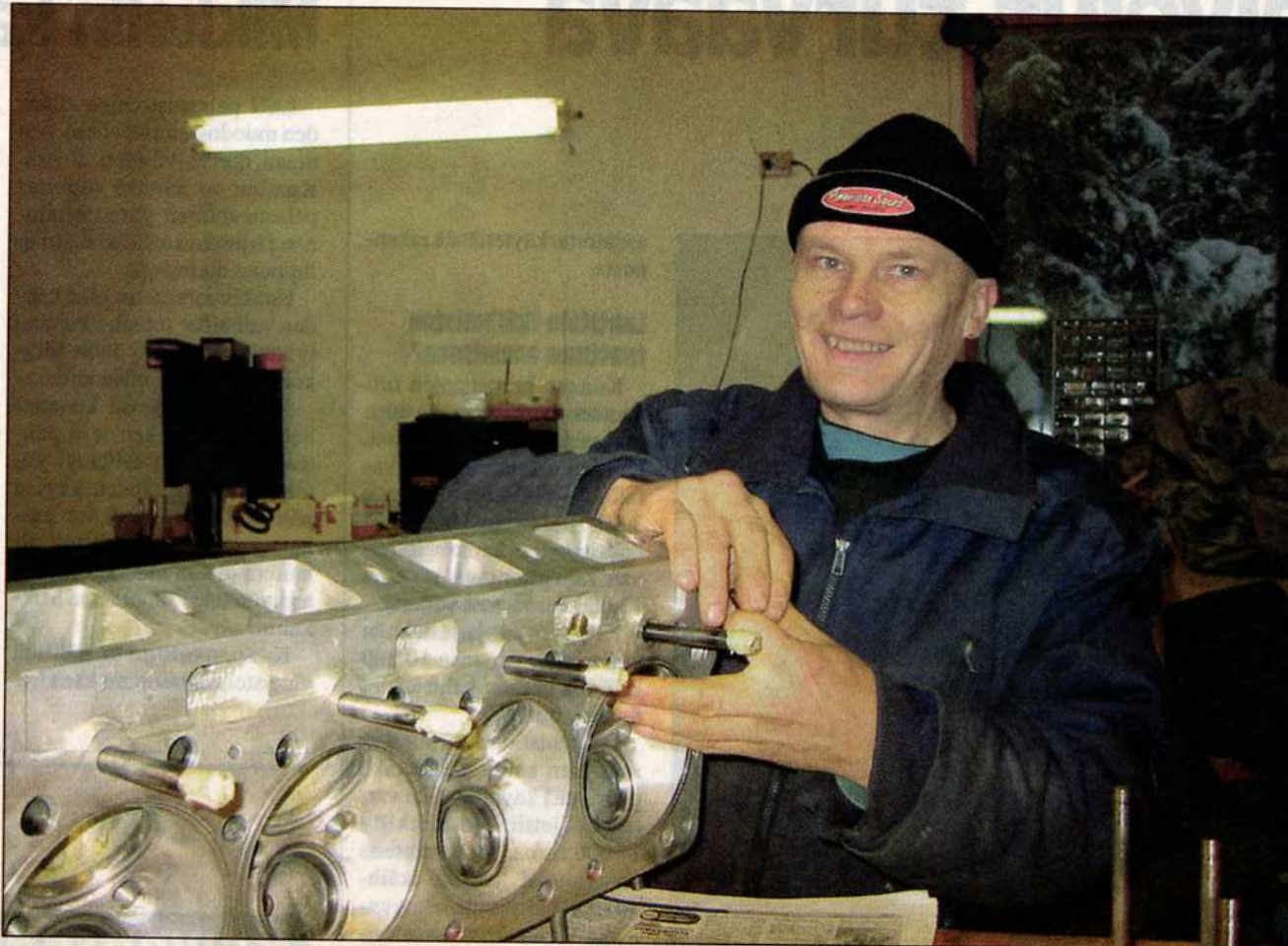
Auton tehojen hiominen äärimmilleen on Artoille erityisen mieluista. Nyt työn alla on Lassi Luoman kiihdytysauton V8-moottorin sylinterikannet: työ on kestänyt 1,5 kuukautta ja tehoa on tullut 100 hevosvoimaa lisää.
