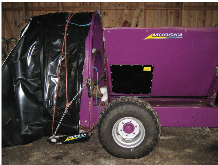
Kuva 5. Tuubituslaite ja tuubimuovia.
