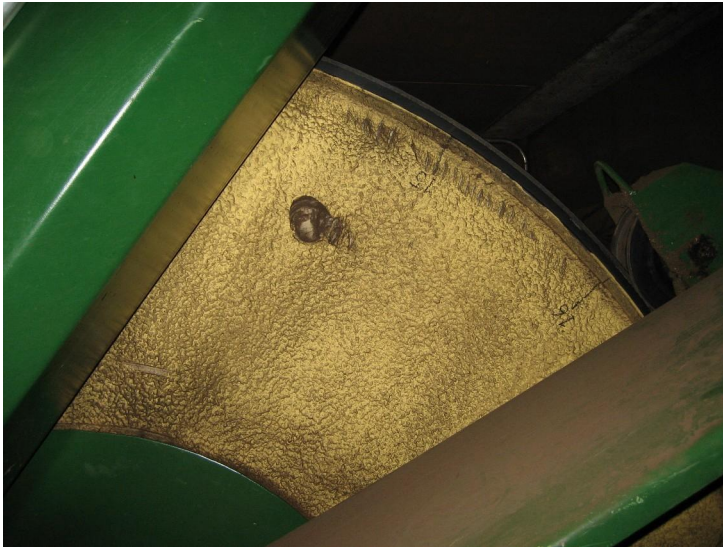
Kuva 2. Kuvassa näkyy osittain Poni-Haan rumpukompostorin rummusta. Rummun ympärillä on lämpöeristettä.
