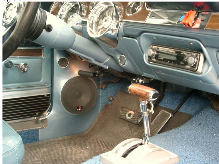
Cleaner Audio-System-Einbau mit Subwoofer in der Durchreiche und sauber verkleidetem Amplifier im Kofferraumboden. Unten die formschönen Kick-Panels und der Pioneer-Spieler
