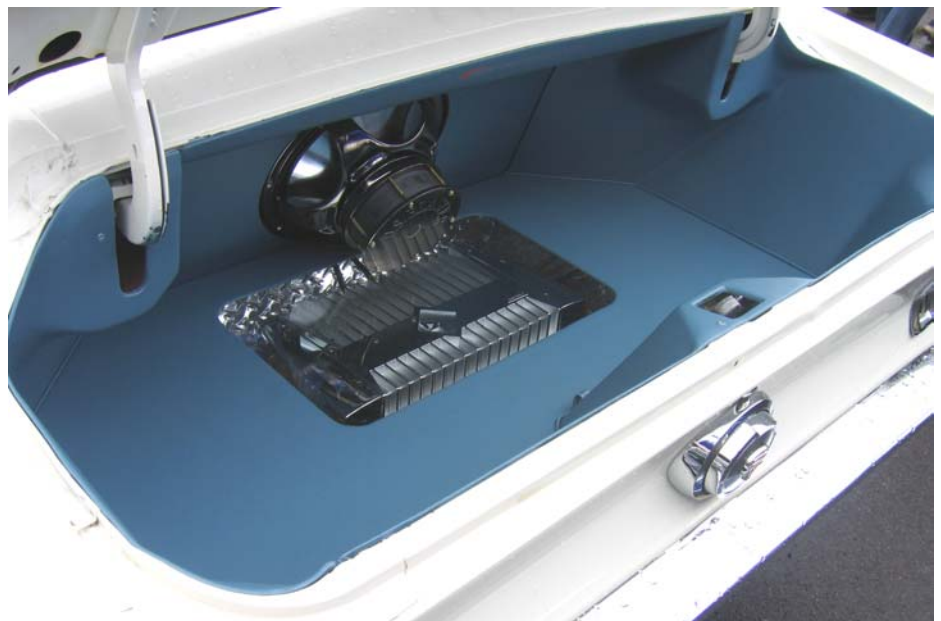
Cleaner Audio-System-Einbau mit Subwoofer in der Durchreiche und sauber verkleidetem Amplifier im Kofferraumboden. Unten die formschönen Kick-Panels und der Pioneer-Spieler
