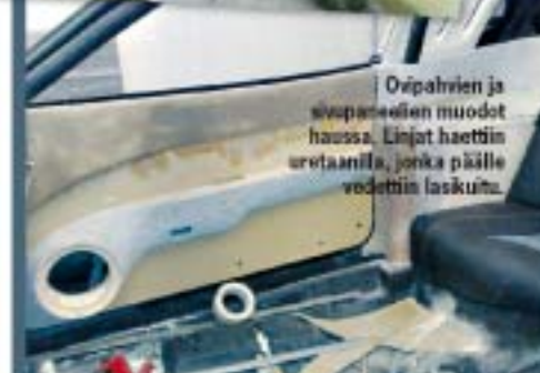
Siuasta suorattiin Stinger Roadkill-äänieristysmatolla.
