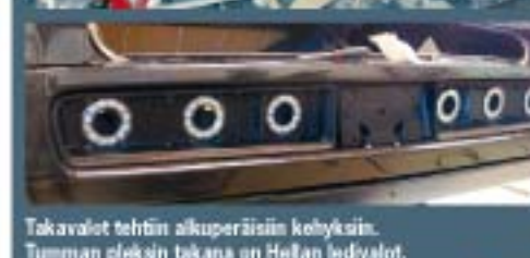
Takavalot tehtiin alkuperäisiin kolyksiin. Tumman pleksin takana on Heilan ledvalot.
