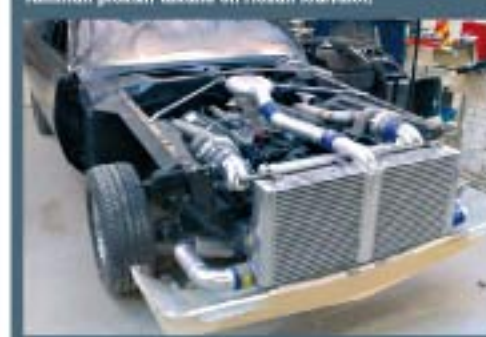
Tarpeeksi suurta cooleria ei löytynyt valmiina, joten sopira tehtiin itse, yhdistämällä kaksi kennoa vierokkään ja hitsaamalla yhteinen ulostulo ylös keskelle. Näin saatiin mahdollisimman yksinkertainen ahtoputkisto.
