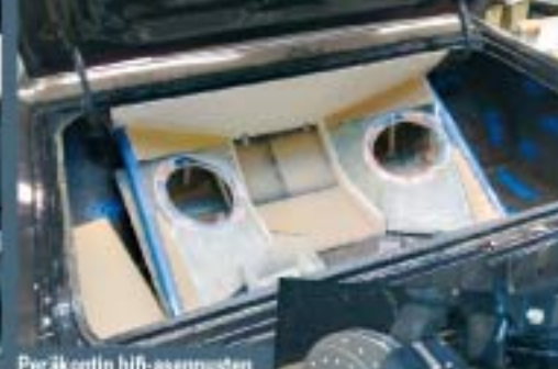
Peräkotelin hifi-asennusten muodot määräytyivät turvakaarien mukaan, sillä ne yltävät aina takimaisiin jousenkiinnikkeisiin asti.
