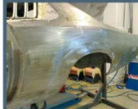
Kymmenien työtuntien jälkeen korjatut ja tinautetut takalokarit malettiin uudenvärisiltä.
