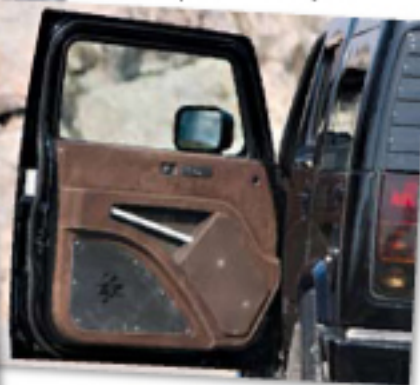
(Alh.) Alkuperäisistä ovipalheista käytettiin vain reunat. Uudet muodot haettiin vanerilla ja lasikuidulla, ja niihin tehtiin paikat kaiutinsarjoille.
