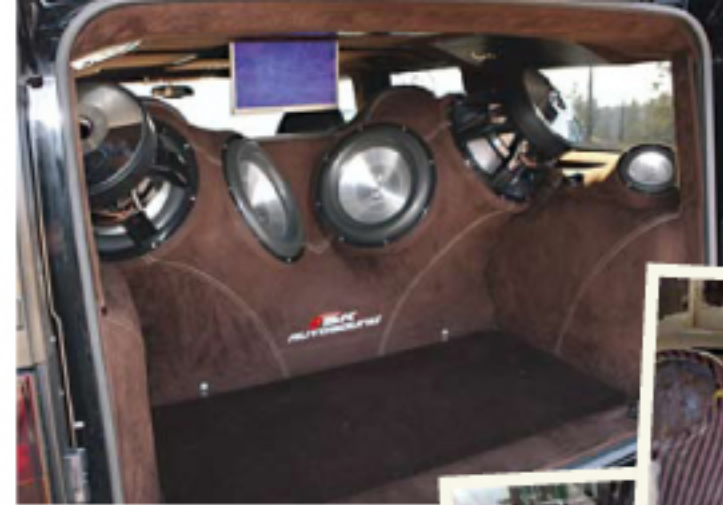
Ground Zeron 15" subbareiden seurana ovat samankokoiset passiivisäteilyt. Kotelo on valmistettu lasikuidusta ja mdf-levystä. Elementit asennettiin magneett ulospäin, mikä pienentää kotelotarvetta ja säästää tavaratilaa.
