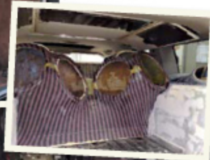
Ground Zeron 15" subbareiden seurana ovat samankokoiset passiivisäteilyt. Kotelo on valmistettu lasikuidusta ja mdf-levystä. Elementit asennettiin magneett ulospäin, mikä pienentää kotelotarvetta ja säästää tavaratilaa.
