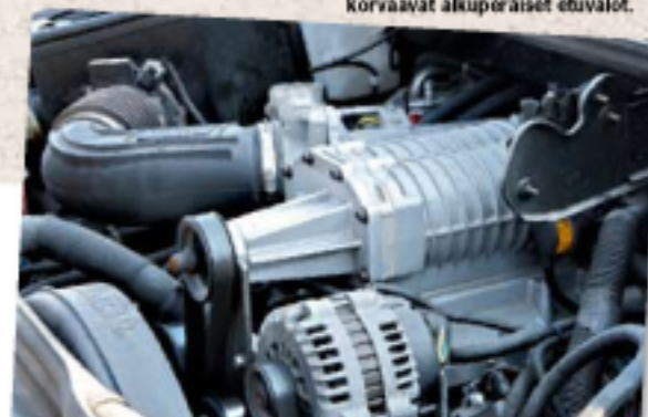
Kuusilitrinen veekasi saa lisäpuhtia Magna Chargerin remmiahtimesta. Ilmanottoa on parannettu vapaavirtausuodattimella.
