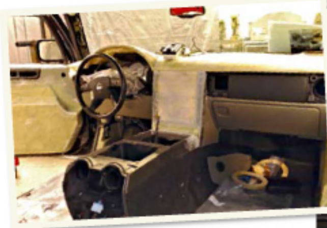
Kojelaudan päällinen muotoiltiin uudelleen. Uusittuun keskikonsolin integroitiin ilmajousituksen ohjauspaneeli ja kosketusnäyttöä varustettu dvd-soitin.
