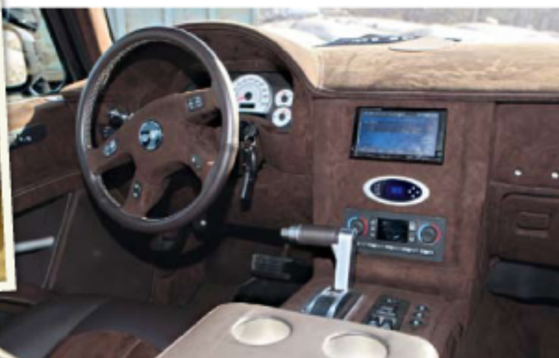
Kojelaudan päällinen muotoiltiin uudelleen. Uusittuun keskikonsolin integroitiin ilmajousituksen ohjauspaneeli ja kosketusnäyttöä varustettu dvd-soitin.
