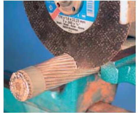
Jäysteetön katkaisu komposiittiaineissa (esim. teräsvaippainen alumiini).
