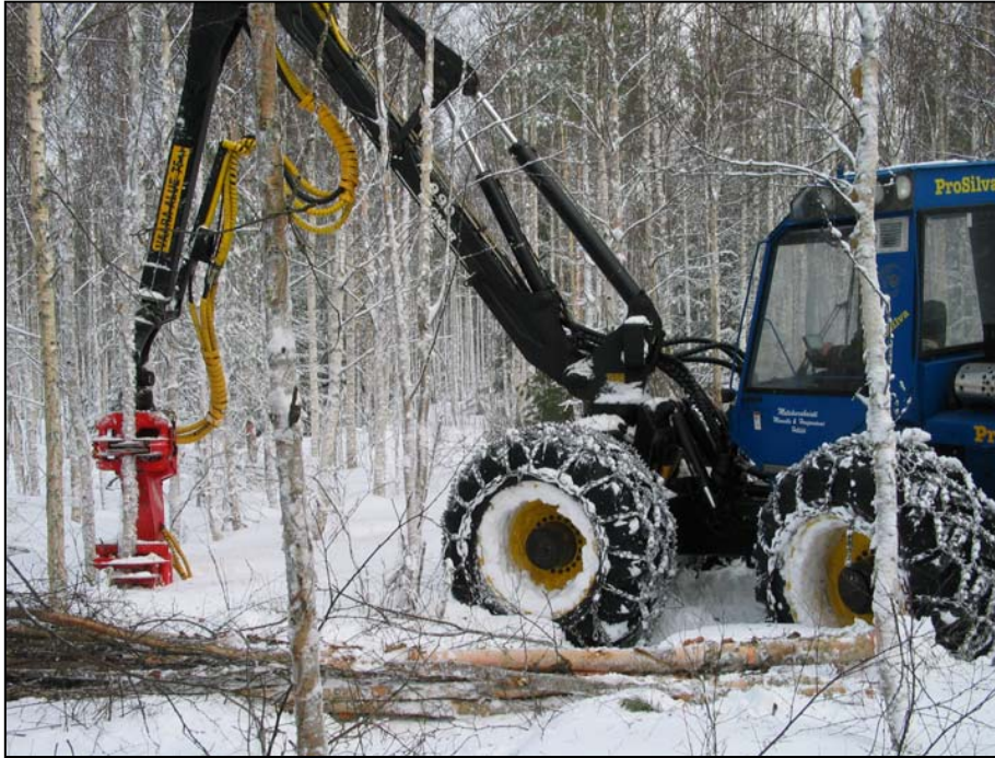
Kuva 2. ProSilva hakkuukone varustettuna Naarva-energiapuukouralla hakkuulla Eskolan leimikolla.
