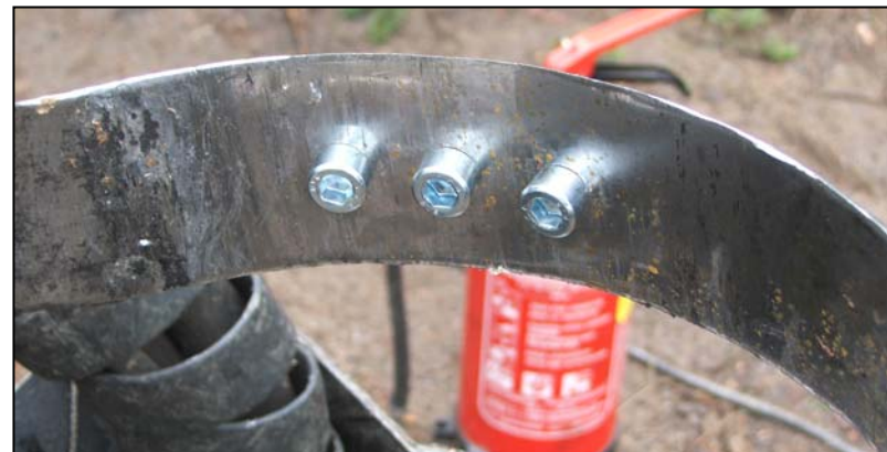
Kuva 1. Karsintateriin lisätyt pultit.
