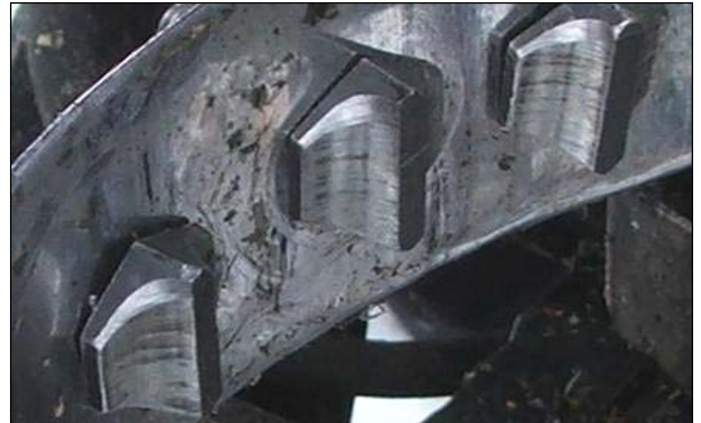
Kuva 3. Hakuukoneen karsintateriin asennetut aisausterät
