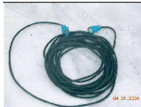
Liitäntäjohto, jolla matkailuajoneuvo liitetään sähköverkkoon.
