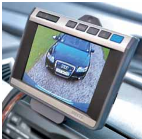
Peruutettaessa kytkeytyy laakulmaobjektiivi automaattisesti päälle ja näyttää välittömästi ajoneuvon takana olevan alueen.
