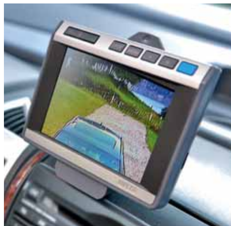
40° kauko-objektiivi näyttää kuvaa kauemmas ja sitä voidaan käyttää mm. ajon aikana takana tulevan liikenteen seuraamiseen.
