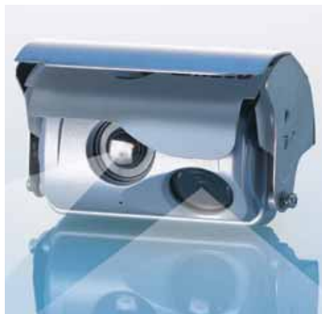
CAM33C1 kamerassa on kaksi objektiiviä, joiden kuvakulmat ovat 140° (laajakulma ajoneuvon takaosan valvontaan) ja 40° (kauempana takana tulevan liikenteen seuraamiseen). Moottoroitu suojalappä ja IR-LED-lamput pimeävalaisuun.
